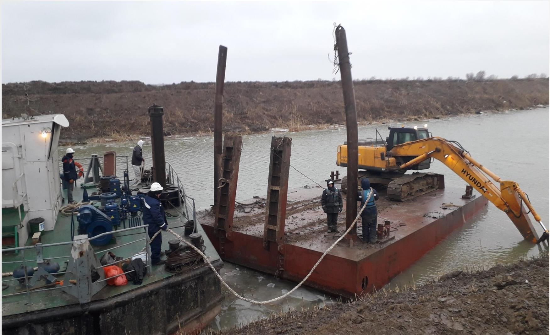
Пантонный экскаватор на базе Hyundai Robex, производительностью 25 м<sup>3</sup>
