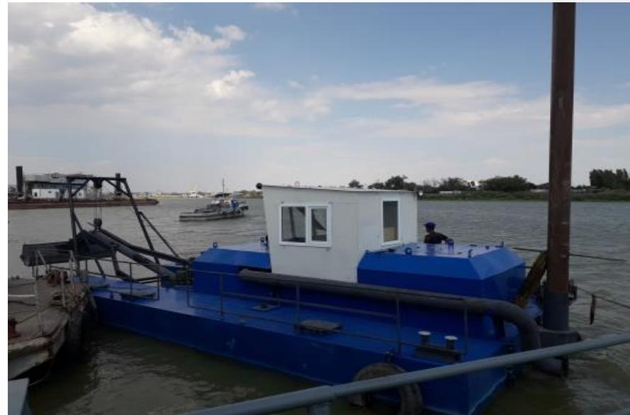
4 единицы землесосных плавучих снарядов, производительностью по пульпе 800 м<sup>3</sup>/час
