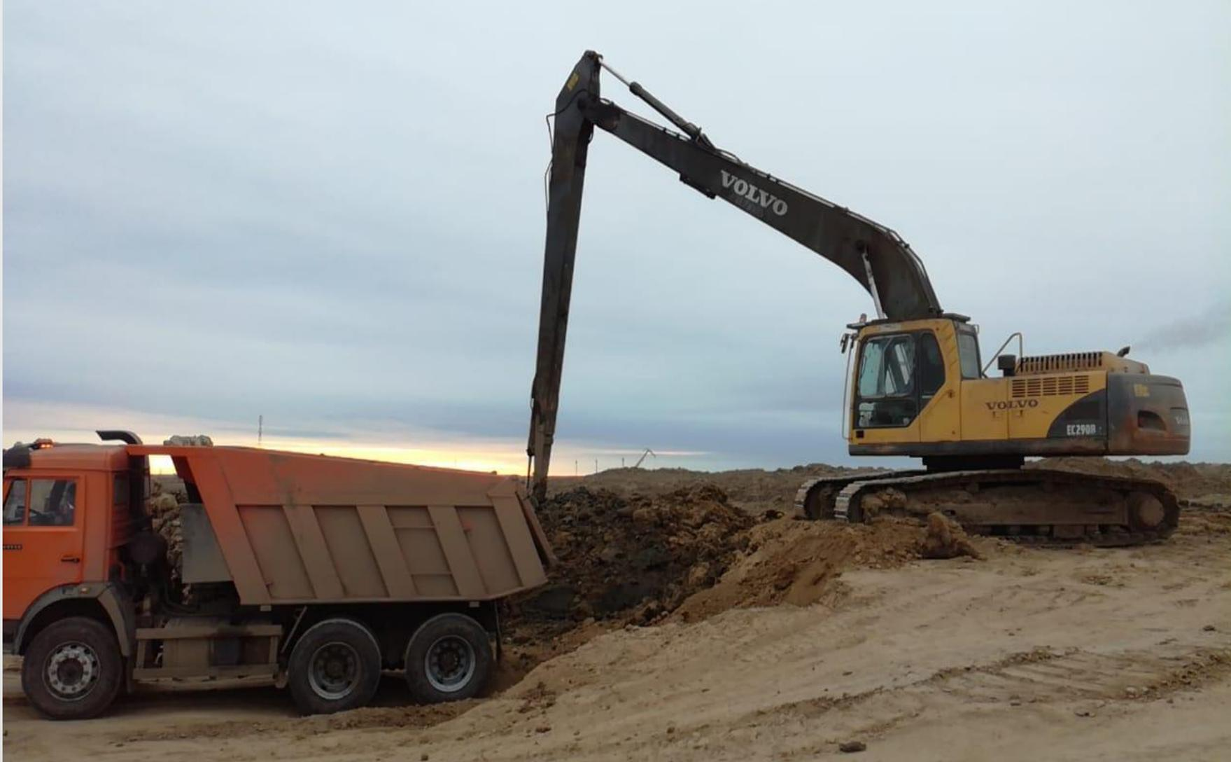
Экскаватор VOLVO EC 290 , стрела 20 м., производительностью 28 м<sup>3</sup>
